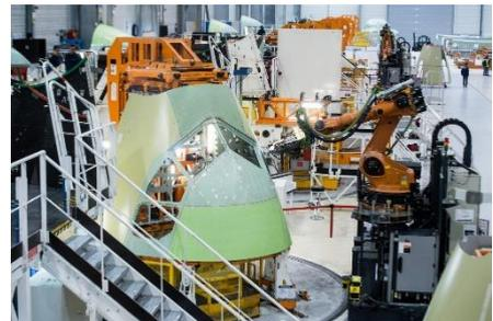
En complément de ses activités d'assemblage, STELIA Aerospace développe et fabrique, pour ses clients européens et américains (Airbus, Boeing, Bombardier, Bell, Embraer...), des **pièces d'aérostructures complexes composites et métalliques** (+ de 7,5 millions de pièces livrées en 2020), ainsi que des **systèmes de tuyauteries complexes**.
